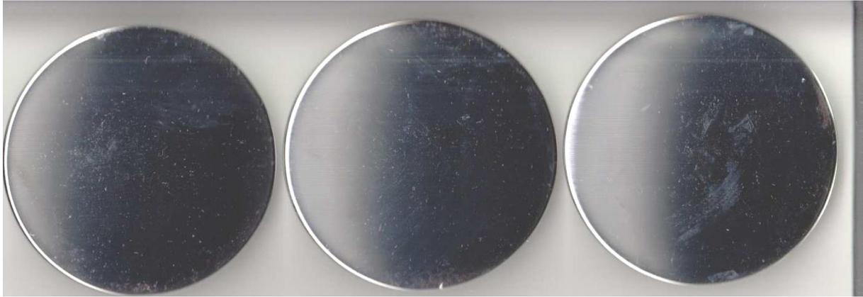
Echantillons au bout d'un test CASS de 96 h.
